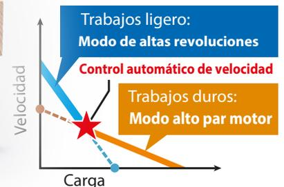
El sistema ADT cambia automáticamente la velocidad de corte ajustándose a la carga de trabajo para una operación óptima.
