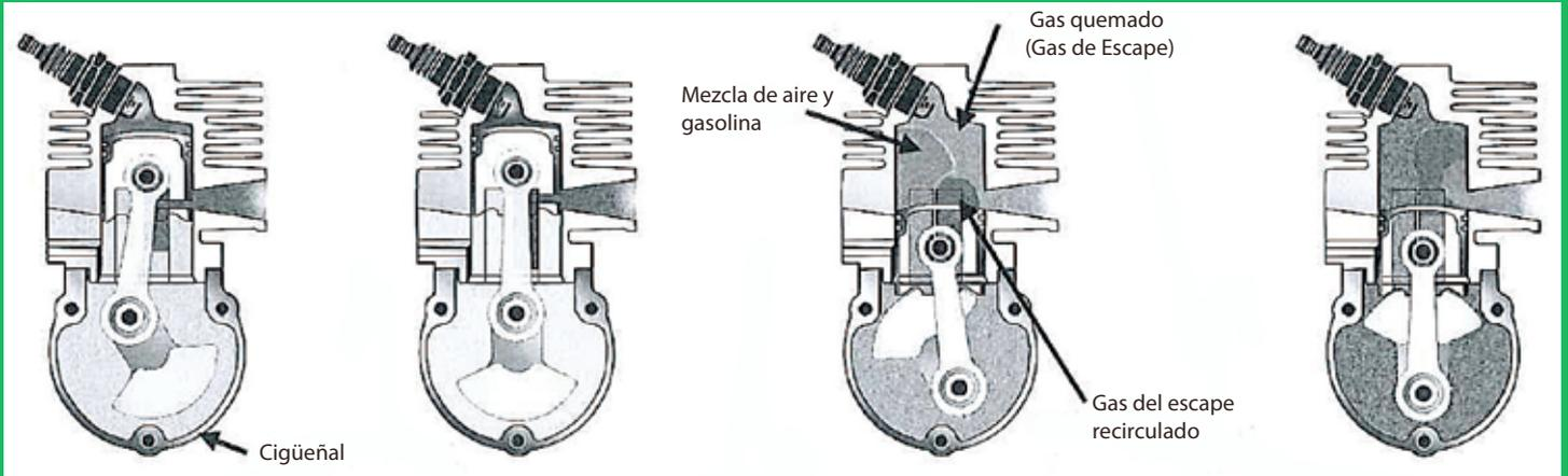
Parte del gas reciclado imita al sistema de 4T bloqueando la mezcla en el conducto de admisión para que no sea expulsada antes de terminar al proceso de ignición.
